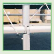
**TUBO** in alluminio anodizzato Ø 50 mm, spessore 3 mm, forato. **ANCORA** di fissaggio ad elica, zincata, lunghezza 80 o 100 cm. **SNODO** in alluminio pressofuso con anima interna in acciaio. **ELASTICO** di fissaggio del telo al tubo.
